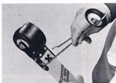
Posizionate la struttura di supporto del ruotino in posizione perpendicolare alle forcelle della ruota anteriore
