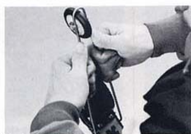
Ruotare la struttura fino a passare sopra i paraspruzzi. L'operazione è più semplice se si procede da un lato alla volta
