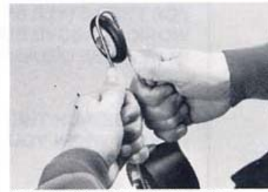
Mantenendola allargata, ruotare la struttura fino a superare le piastrine di bloccaggio
